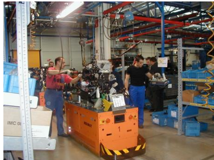
Abbildung 4: FTF als Montage-Plattform 5
