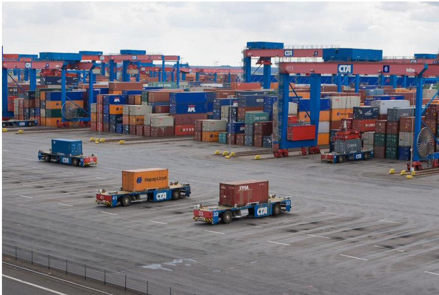
Abbildung 5: Drei Automated Guided Vehicles (AGV) vor einigen Double Rail Mounted Gantry Cranes (DRMG) im Hafen Hamburg-Altenwerder 6
